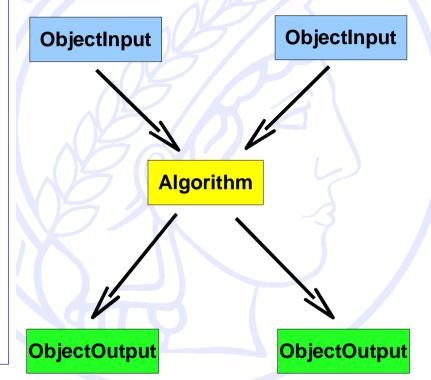
Script new Algorithm(<*Algorithm properties>*); new ObjectOutput(<*dbO1>*, <*Event characteristics1>*); new ObjectOutput(<*dbO2>*, <*Event characteristics2>*); new ObjectInput(<*db1>*); new ObjectInput(<*db2>*);
